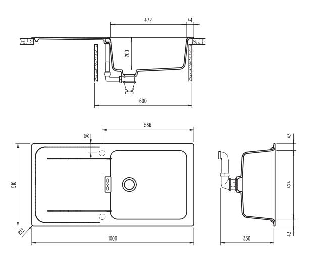
Installazione: SOPRATOP Installazione: SOTTOTOP POSITIVO
