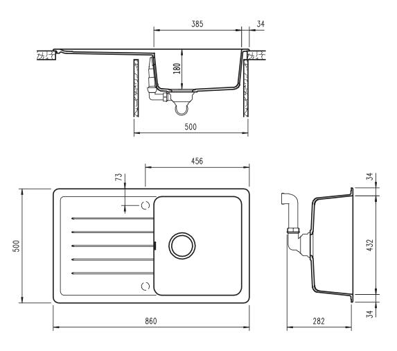
Installazione: SOPRATOP Installazione: SOTTOTOP POSITIVO
